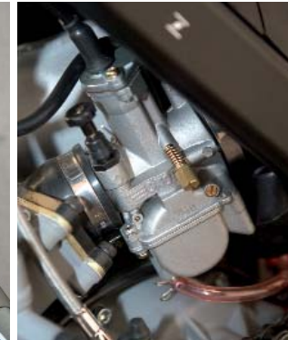
Race only: Gut, aber leider nicht zulassungsfähig, der 28er OKO-Flachschiebervergaser.
