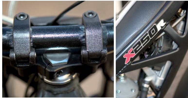
Schnell: Die Lenkerklemmung in Scharnierausführung spart im Ernstfall wertvolle Zeit.
