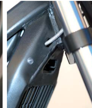
Aufgeräumt: Der sauber verlegte Kupplungs-schlauch wirkt ordentlich.
