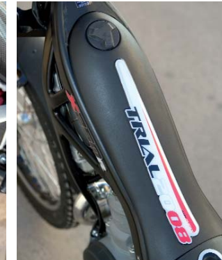
Ohne Gummi: Der Tankstutzen kommt ohne Belüftungsschlauch aus.
